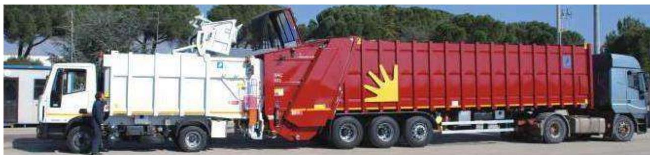
Figura 3 - Esempio di trasbordo da minicompattatore ( $10,00\text{m}^3$ ) ad un compattatore di capacità grande ( $40,00 \div 45,00\text{ m}^3$ )
