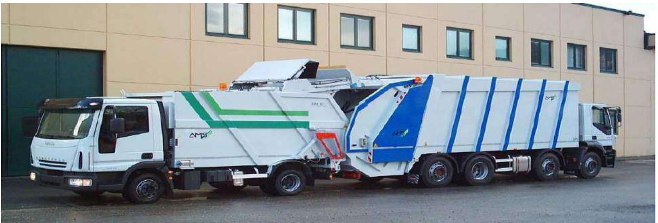
Figura 1 – Esempio di trasbordo da un minicompattatore (7,00m<sup>3</sup>) ad un compactatore di capacità media o grande (25,00 ÷ 30,00 m<sup>3</sup>)
