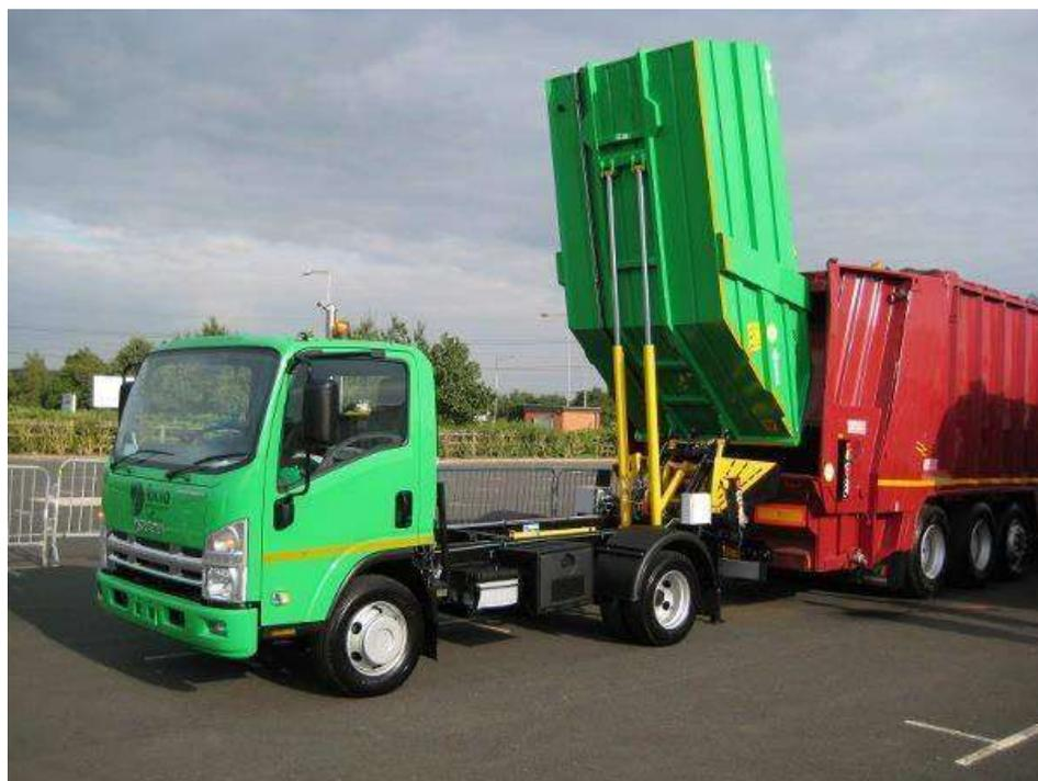
Figura 2 - Esempio di trasbordo da veicolo a vasca con costipatore ( $7,00\text{m}^3$ ) ad un compattatore di capacità media o grande ( $25,00 \div 30,00\text{ m}^3$ )
